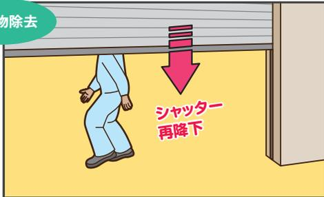
障害物が除かれると、自動閉鎖装置が再度作動して、シャッターは再降下を開始します。
