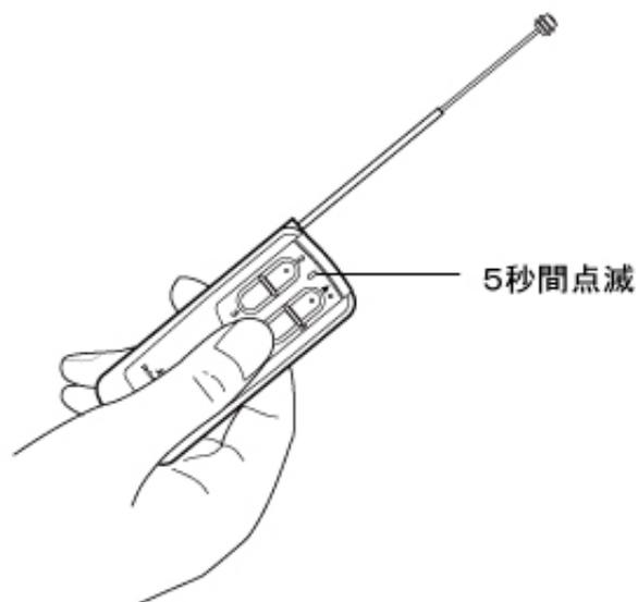
送信操作の後表示灯が5秒間点滅したら、電池の交換時期です。
