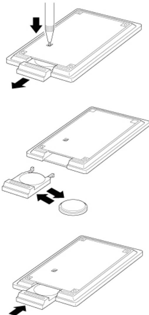
裏面のPUSHスイッチをシャープペンなどの先で押しながら、電池ケースを引き出します。
